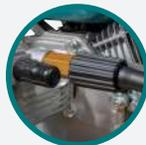
Conexión rápida para colocar la manguera
